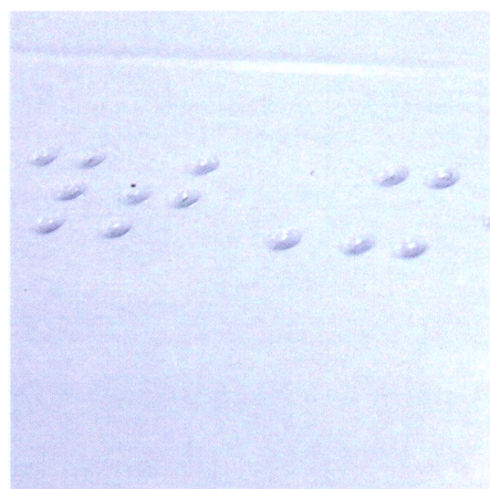
2層構造の金型により、鮮明な点字打刻が可能
