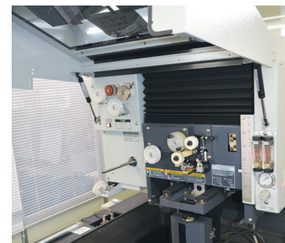
平成25年度補助金で導入したワイヤーカット放電加工機
