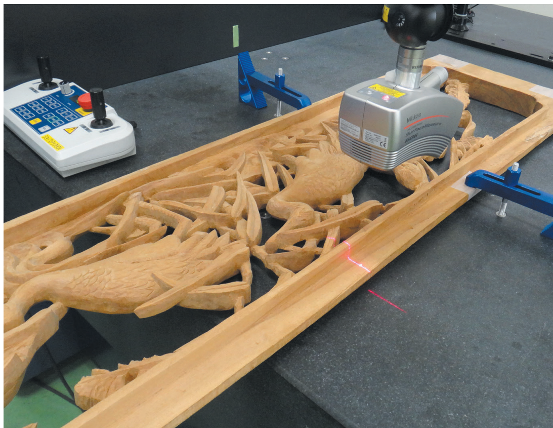
欄間をスキャンするCNC三次元測定機（平成24年度補助金で導入）
