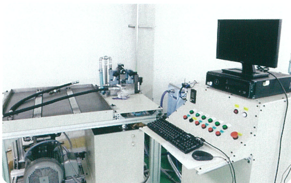
性能検証ができるようにするため、油圧テストスタンドを設計・製作
