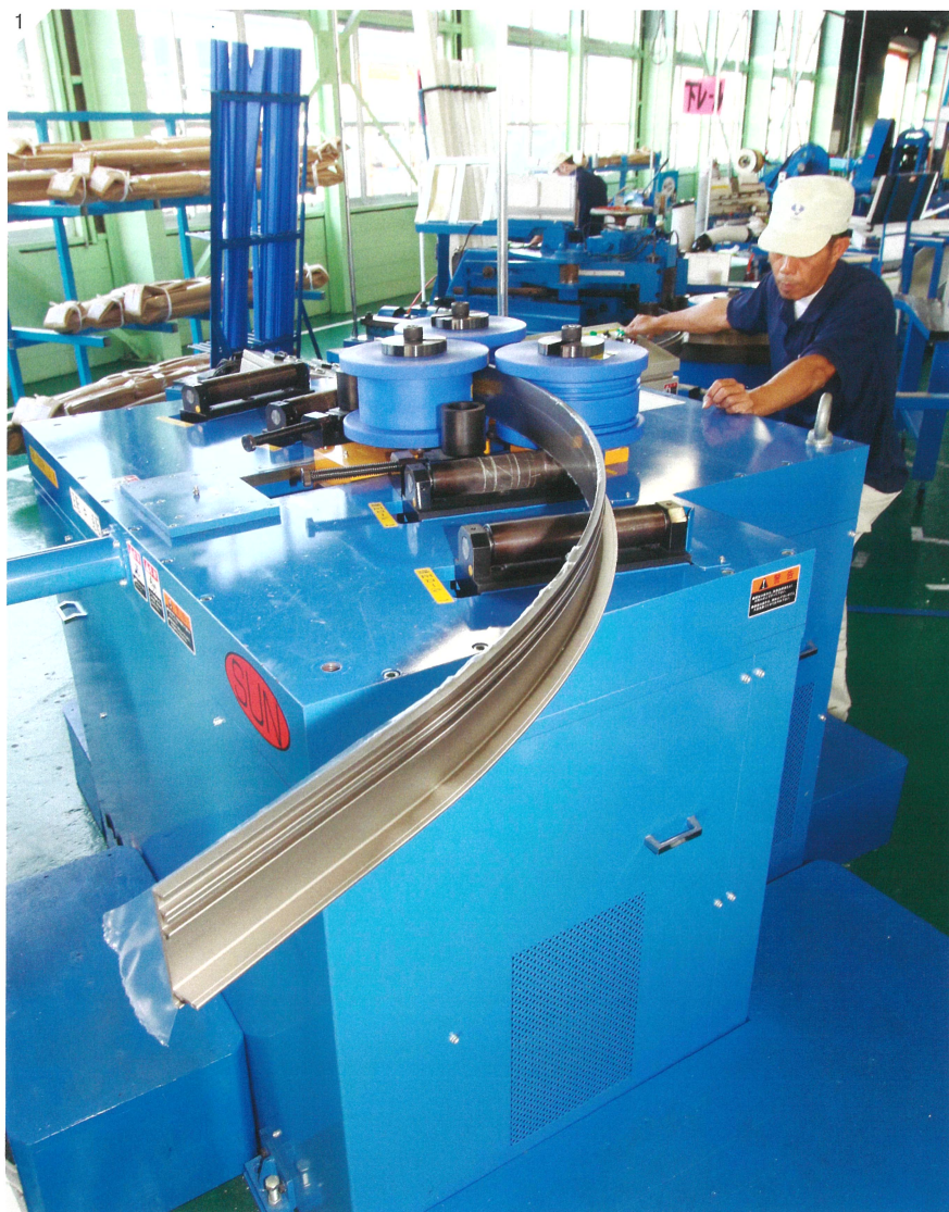
1／「イスターカーテン」用の金属レールをしなやかに曲げていく曲げ加工設備 2／曲げ加工設備を使い、金属レールが直線(左)から半径30センチの急カーブ(右)に変身する 3／都心の店舗に設置した曲線タイプの「イスターカーテン」。導入した曲げ加工設備を使えば、さらに小半径の曲線にも対応できる
