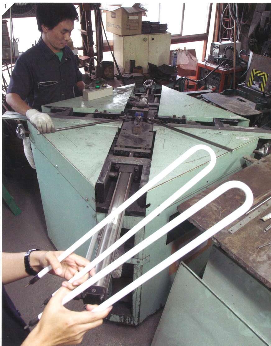
1/自動曲げ機(奥)でU字に加工した超高温 シーズヒーター(手前) 2/絶縁材料となる粉 末状のマグネシア(上)とボロン(下) 3/シーズ ヒーターを横から見る。発熱線を包むように絶縁 材料のボロンとマグネシアが充填されている
