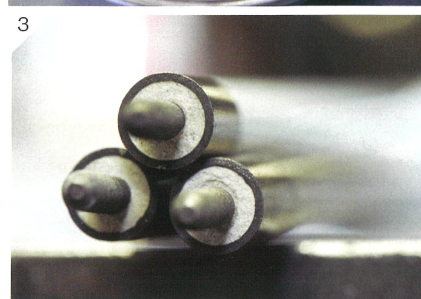
1/自動曲げ機(奥)でU字に加工した超高温 シーズヒーター(手前) 2/絶縁材料となる粉 末状のマグネシア(上)とボロン(下) 3/シーズ ヒーターを横から見る。発熱線を包むように絶縁 材料のボロンとマグネシアが充填されている
