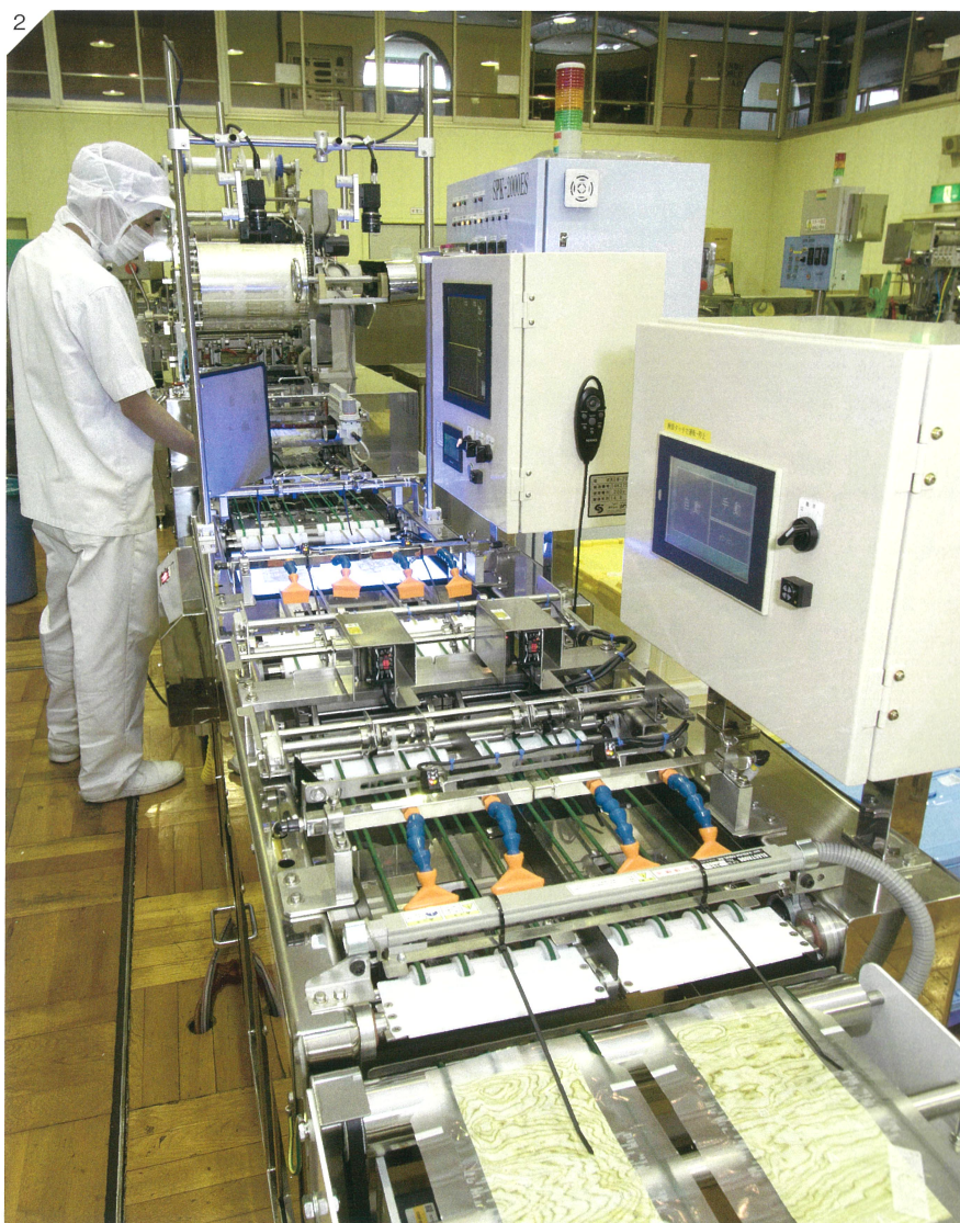
1／ロール状の昆布シートを引き出し、フィルム包装へと送り出す 2／コンビニおにぎり用のフィルム包装ライン。おにぎりの大きさに合わせてカットされた昆布シートが1枚ずつ包装されて出てくる 3／昆布シートを使ったおにぎり
