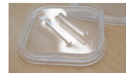
搭載されている PPMgSLT 素子。周期分極構造の模様が虹色に見える
