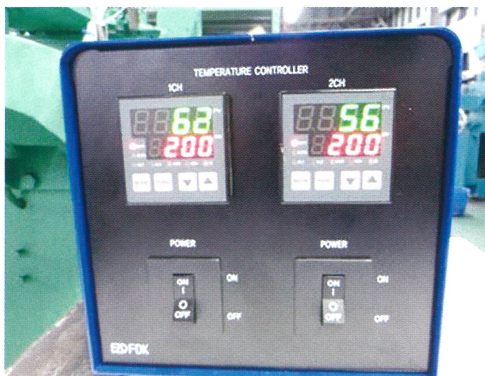
ワイヤー加熱ローラーヒーターの温度コントローラー
