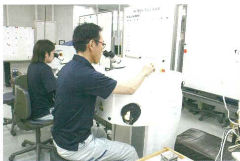
レーザー溶接機による溶接
