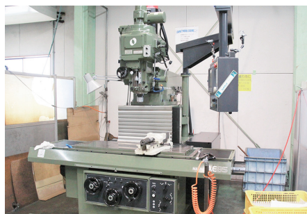
導入した大型（NC）操作フライス盤
