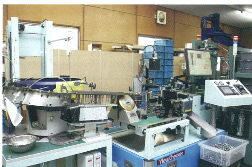
高速画像検査処理装置
