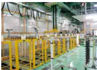
バーコード制御でロボットが稼働する全自動めっきライン
