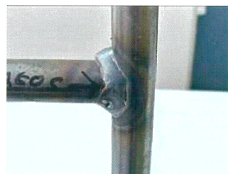
ロボット溶接機メーカーの工場で作成したフレーム。スパッタがほとんど付着せず、ビード外観も美しく仕上がることが確認できた。
