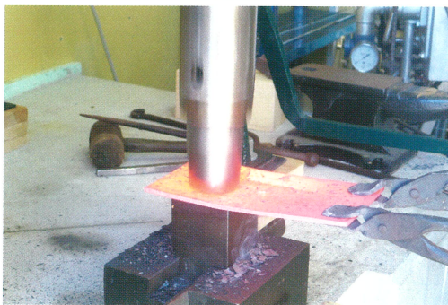
加熱した炉でステンレス鋼材を焼き、スプリングハンマーで鍛造する独自のはさみ製法は、「打ち刃物」にヒントを得たもの。
