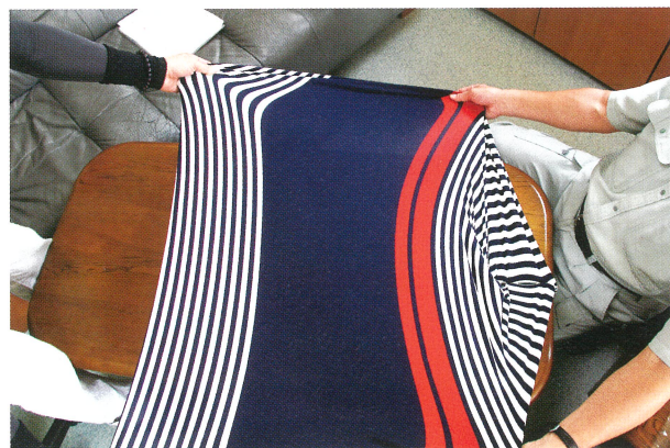
ポリウレタン糸を使用しているため、全体に大きく引き伸ばすことが可能で、かつ回復率も高い。
