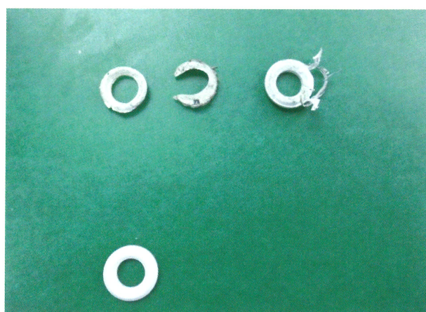
従来のロールコーターのパッキン。下が使用前、上が稼働により磨耗したもの。
