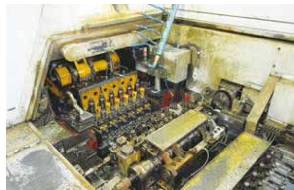
今回開発したナット製造用金型
