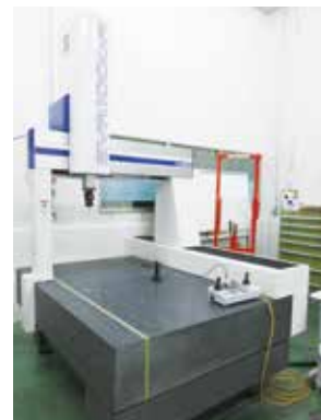
アルミ材を正確に加工するために導入した三次元測定機
