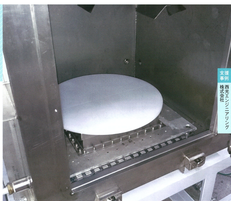
乾燥機の中に設置した真空中で使用可能な重量を測定する高精度ロードセル
