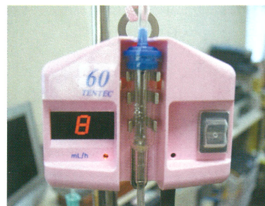
輸液量を表示。輸液の停止や流れすぎなどの場合、アラームと表示で警告する
