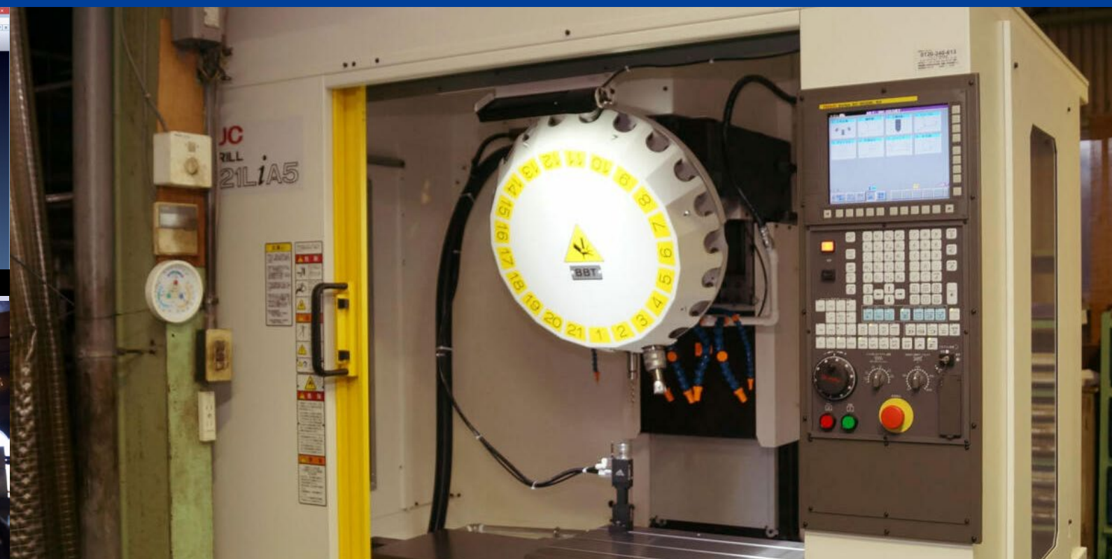
導入したマシニングセンター。従来は難しかった金型の製造もできるようになった
