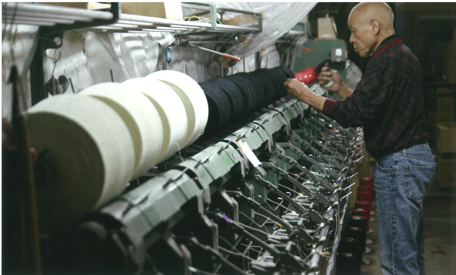
工場内の湿度や糸のテンションを一定に保って糸を巻き替える繊細な作業
