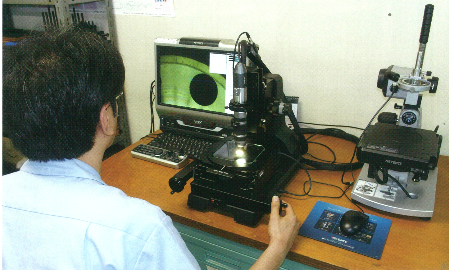
導入したマイクロスコープ。精密加工・微細加工の実際の形状を拡大して画像で表示できる
