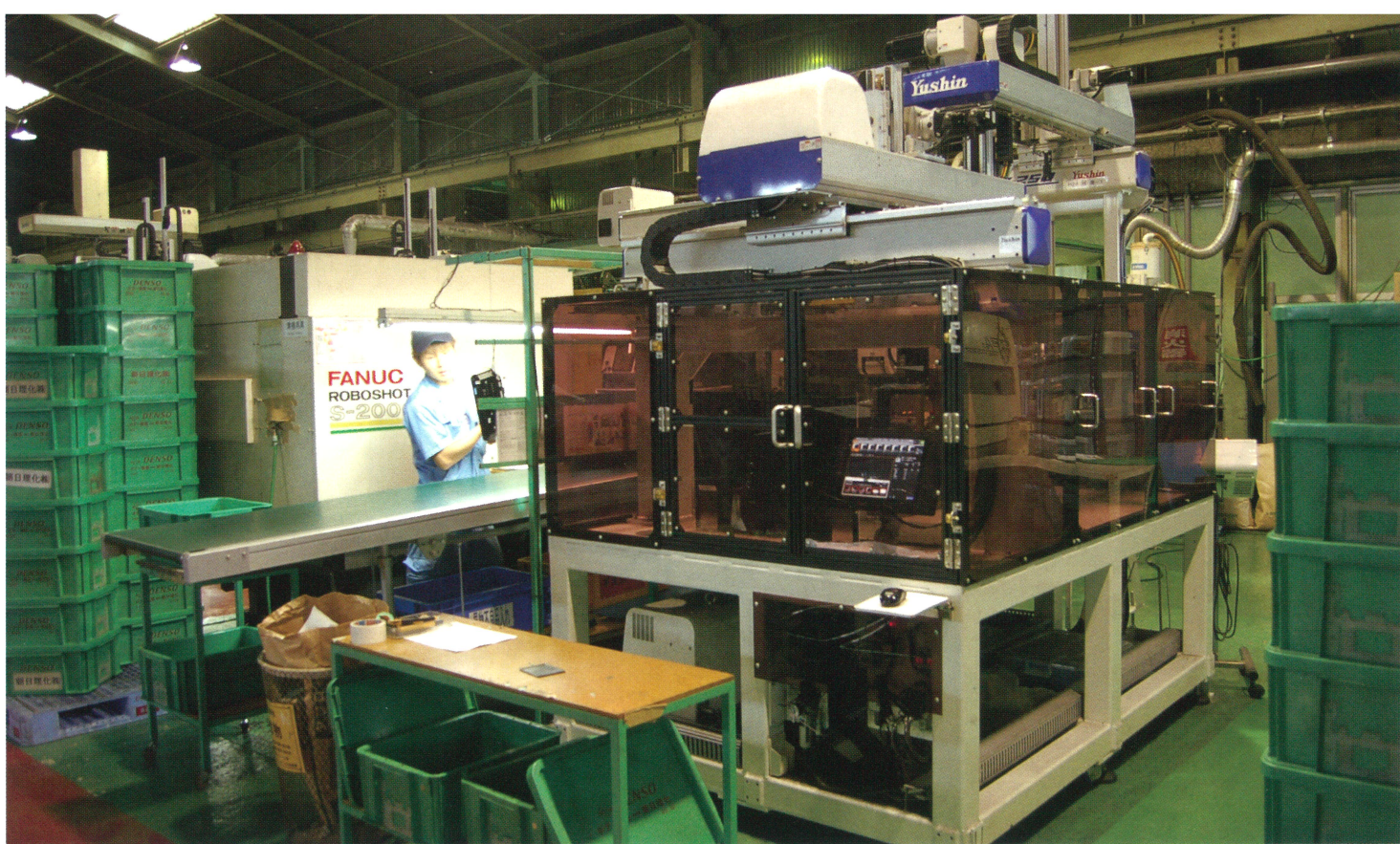
不良品流出ゼロと省工程化実現のため導入した高性能複眼検査システム
