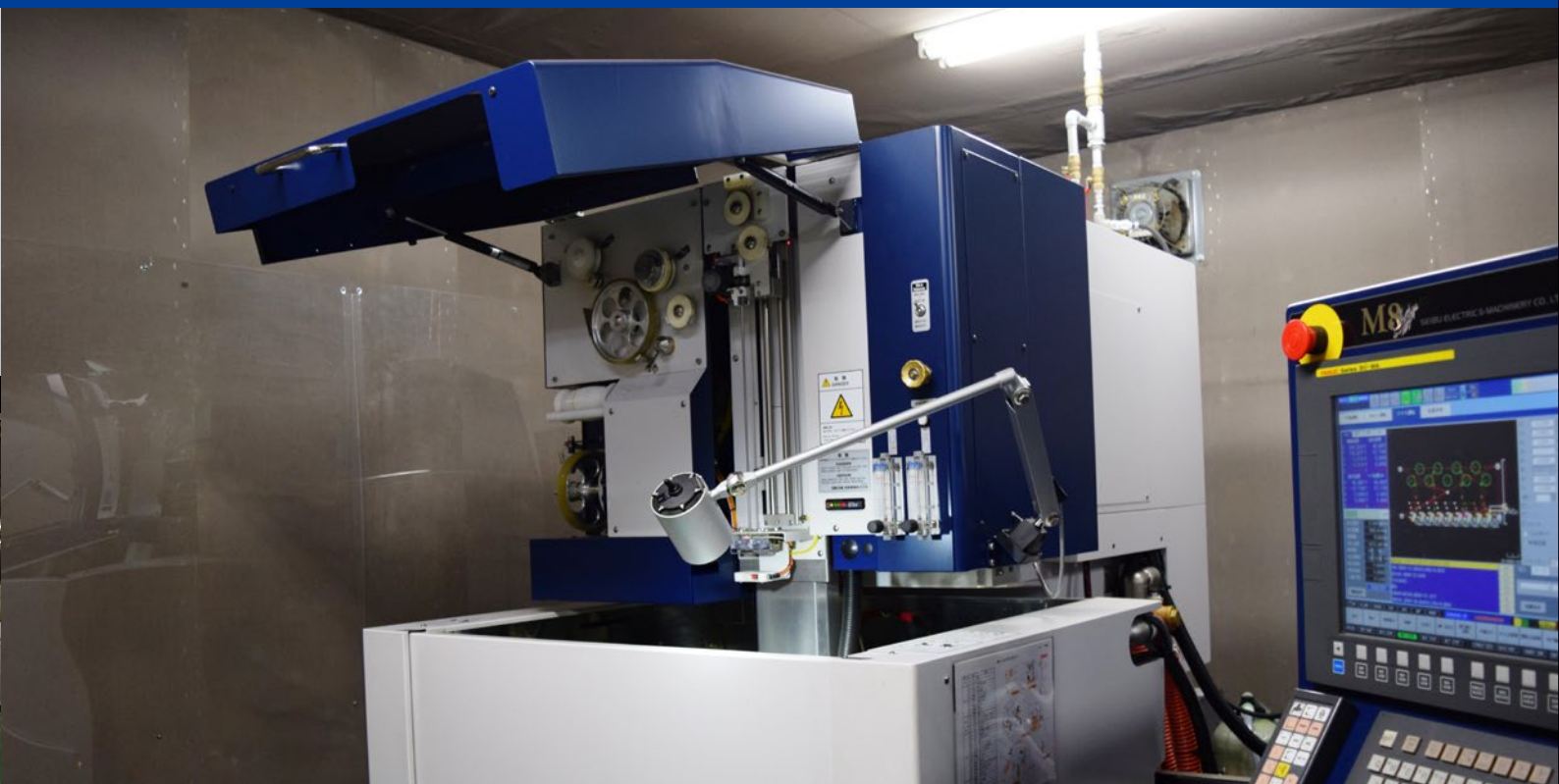
補助金を利用して導入したワイヤ放電加工機。求める機能が充実しているため、採用を決めた
