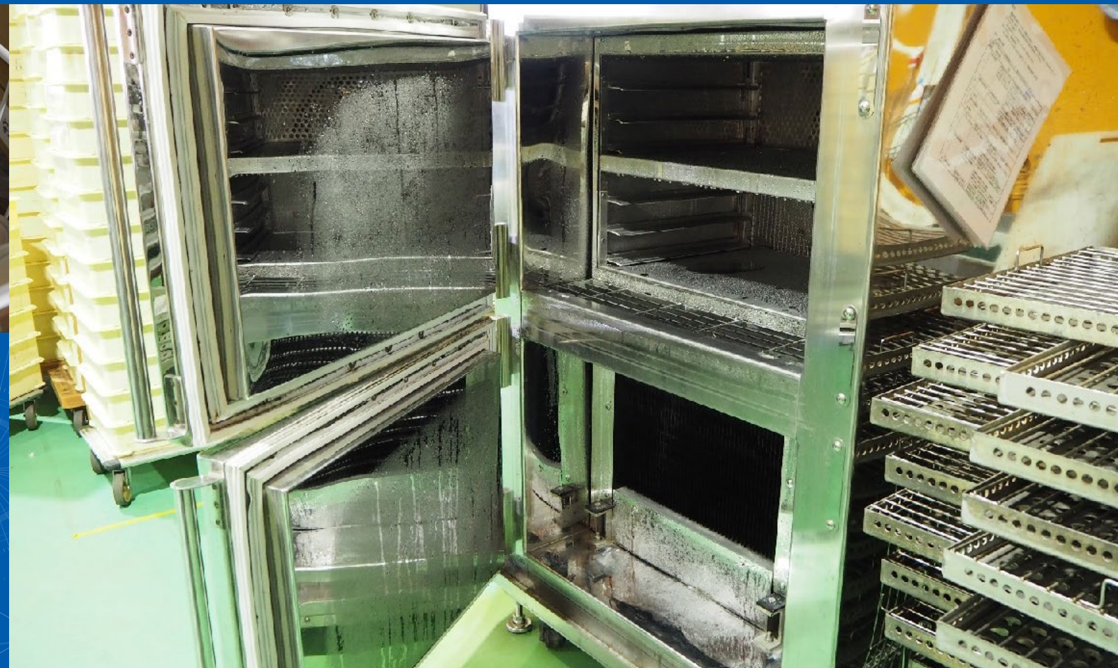
■ マイナス30度Cまでの急速冷凍に使用する「プロトン冷結機」
