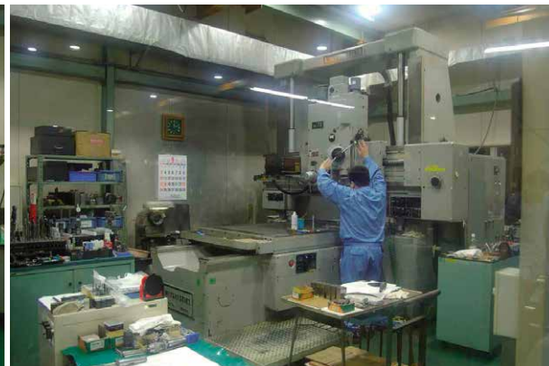
恒温室での治具ボーラー加工
