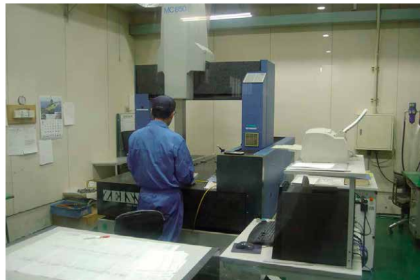
3次元測定機で製品を検査する
