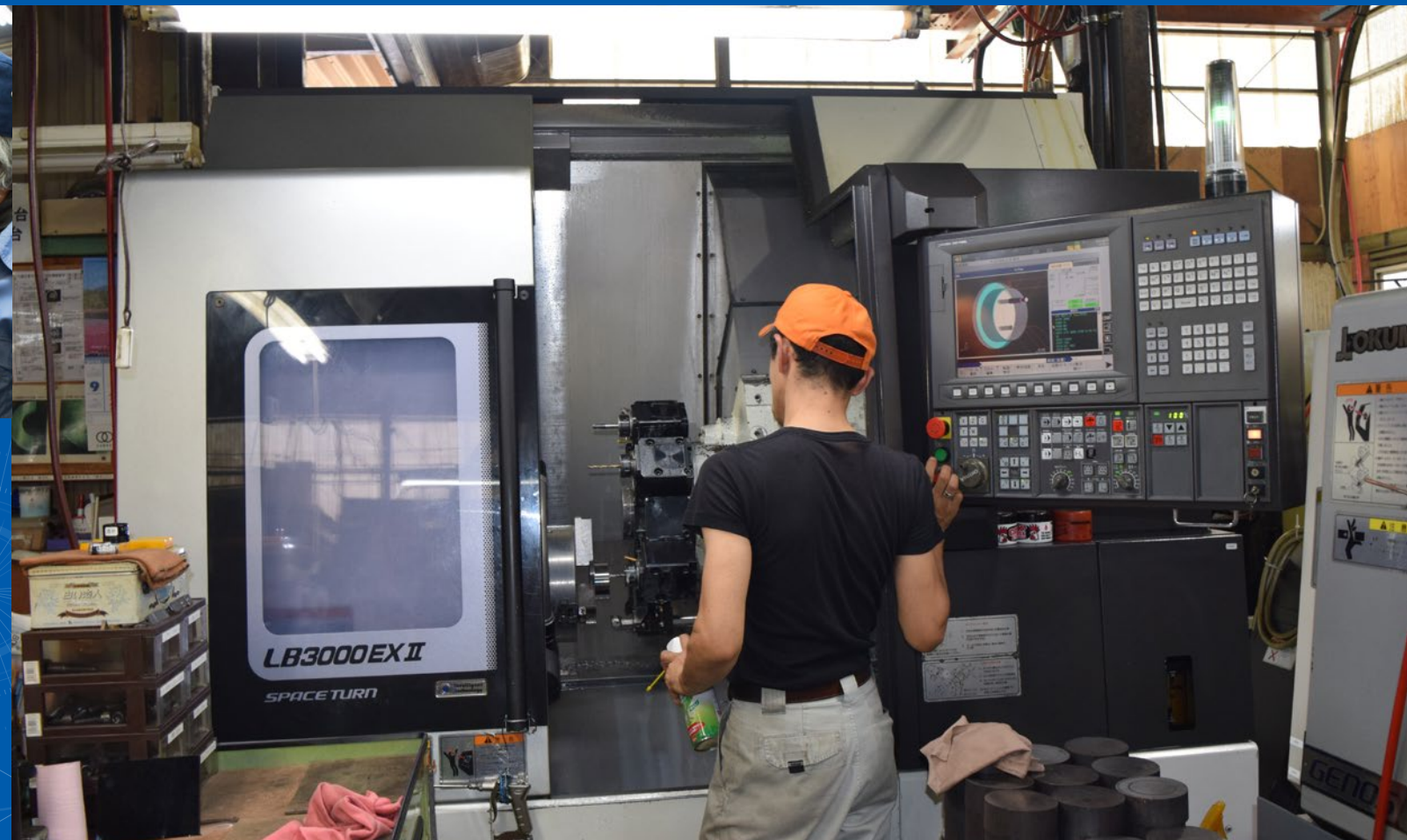
■ 旋盤とフライスの複合加工機導入により、2台加工に比べ格段に生産効率がアップした
