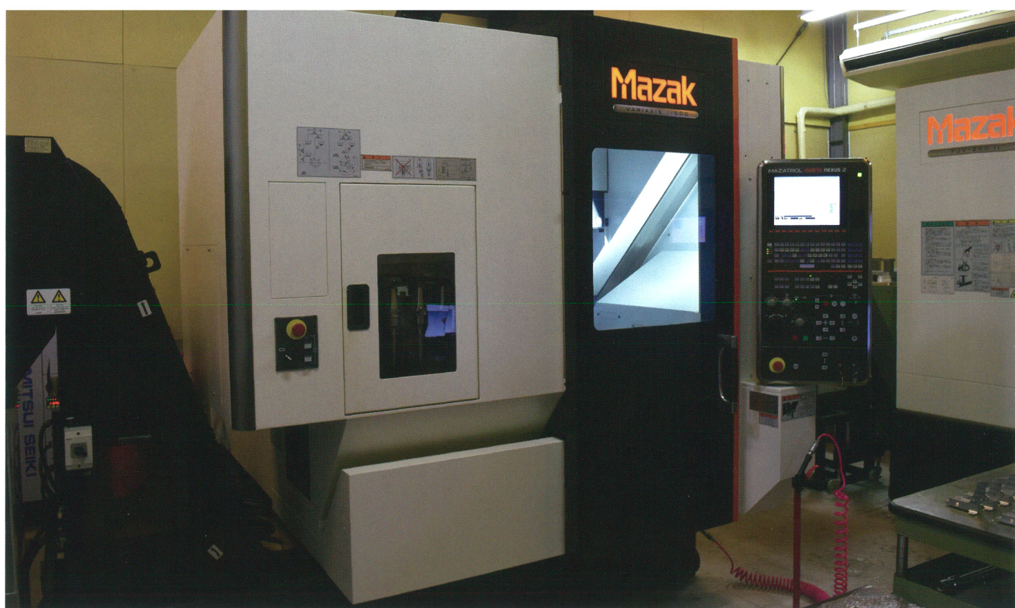
導入したヤマザキマザックの5軸マシニングセンター。航空機部品の加工能力が大幅に向上した
