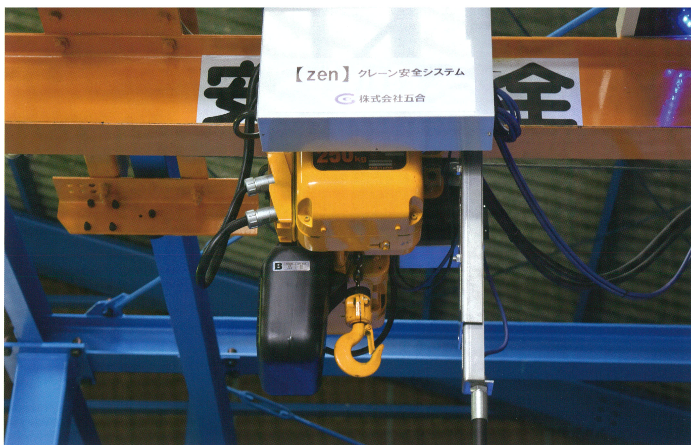
実験棟の天井クレーン。操作情報と移動情報を管理する基板を内蔵
