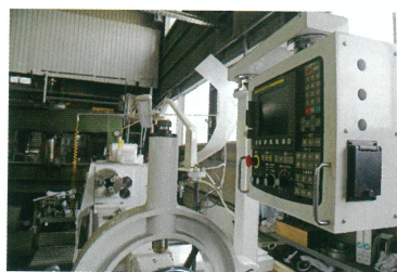
最新鋭のソフトウェアを本体に搭載したCNC普通旋盤。単純な物ならプログラムが自動で仕上げてしまう優れたもの。
