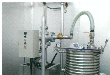
塙社長と機械メーカーとのプロジェクトによって開発した70度前後の低温でガノデリン酸を抽出する今までに無い装置。
