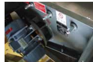
スラリー状(泥状)モルタルの粒子を分けるパイロスクリーン。
