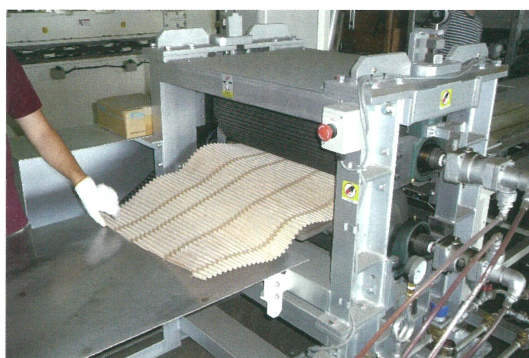
曲り癖熱ロール機による成形
