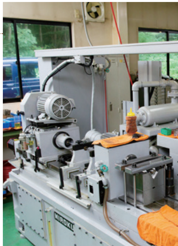
本事業により導入したガンドリル。高精度な深穴あけ加工を自動で短時間で行うことができる。
