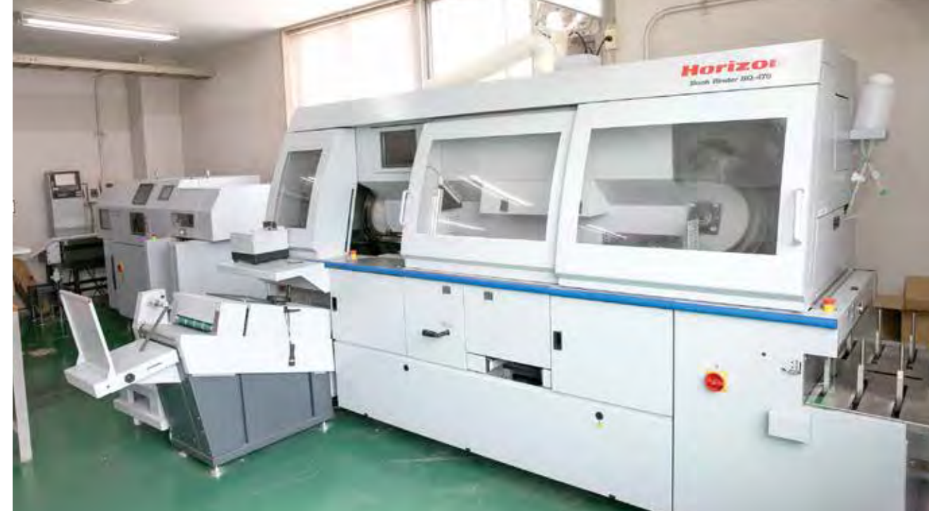
今回導入した設備。他の製本会社でも持っているところは少なく、普通の糊とPUR糊を併用できるので幅広い製本に対応できる
