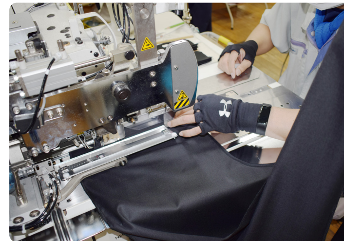
玉縁工程の作業の様子
