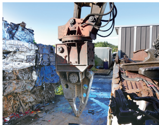
導入した自動車解体用切断機
