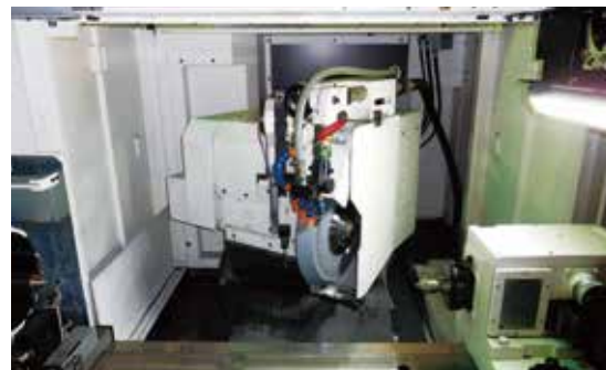
タッチプローブ「マーボスT25G」装着のNC円筒研削盤
