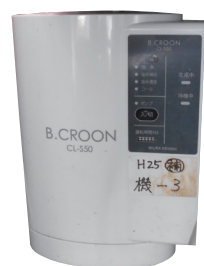
電解次亜水生成装置
