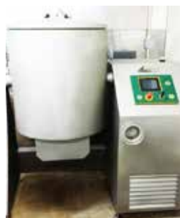
タンブラー・ミキサー ロースハム等の原料の粘着質 を上げる
