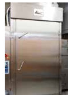
スモークハウス 商品の燻製または加熱処理
