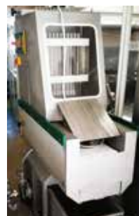
インジェクター 原料に塩水・スパイス を注射する
