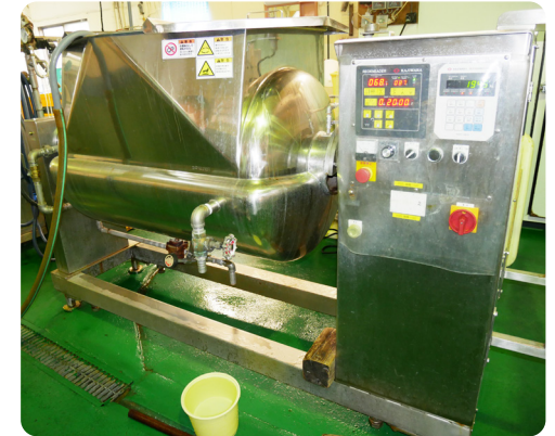
導入した火入れ混合攪拌機
