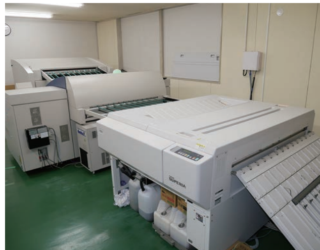
導入したCTPセッター（刷版出力装置）
