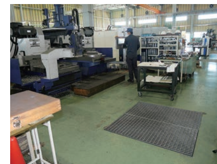
新工場の床にはピット20か所を配置
