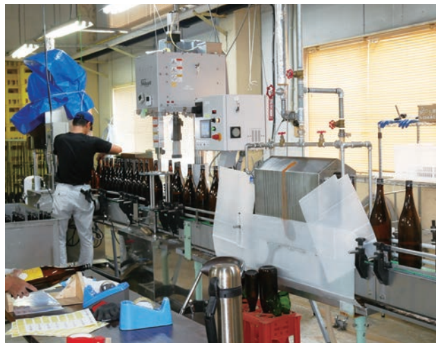
導入したマルチキャッパの稼働の様子(瓶蓋の打栓)
