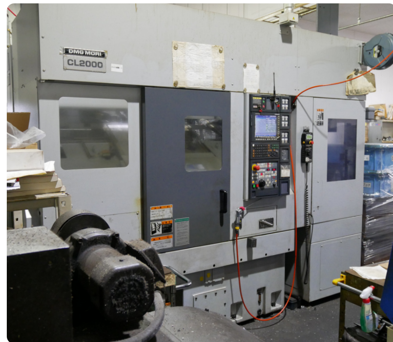
導入したNC旋盤ガントリーローダー仕様
