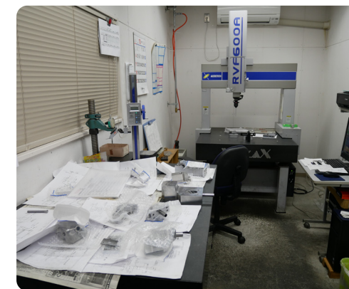
検査室内に三次元測定器を整備
