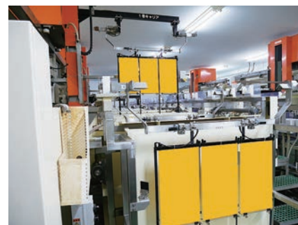
プリント基板のメッキ処理(写真一部加工)
