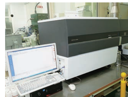
マルチタイプICP発光分光分析装置
