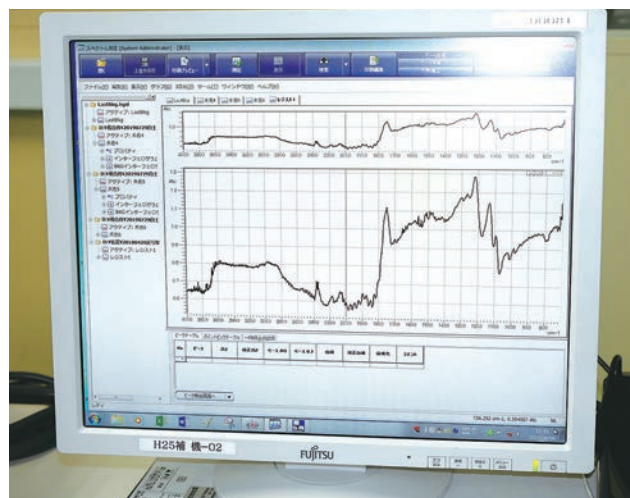
パソコン画面上に出力されたFTIRの計測結果
