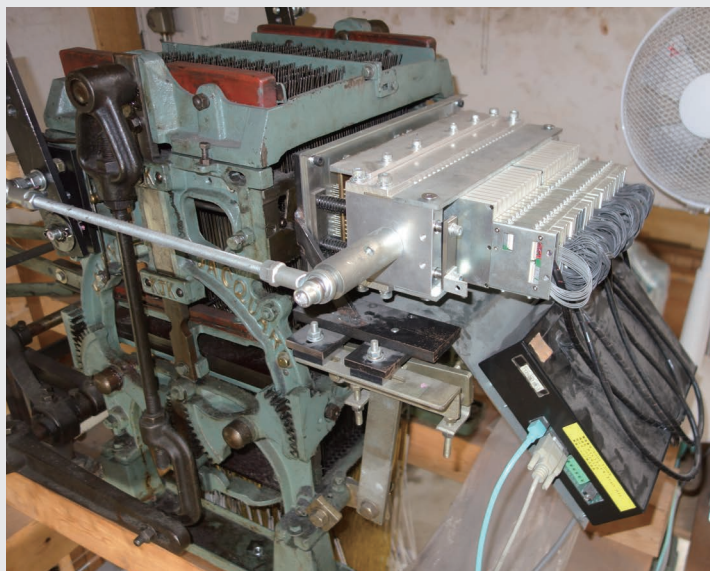
◀▶ダイレクトジャカード。 旧来のジャカードに柄データを読み込ませる装置
