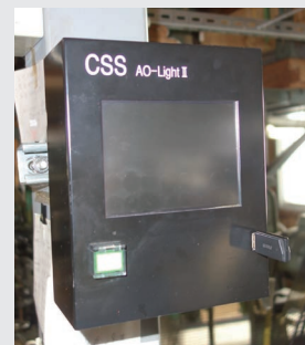
▲USBから柄データをジャカードに送るコントローラー
