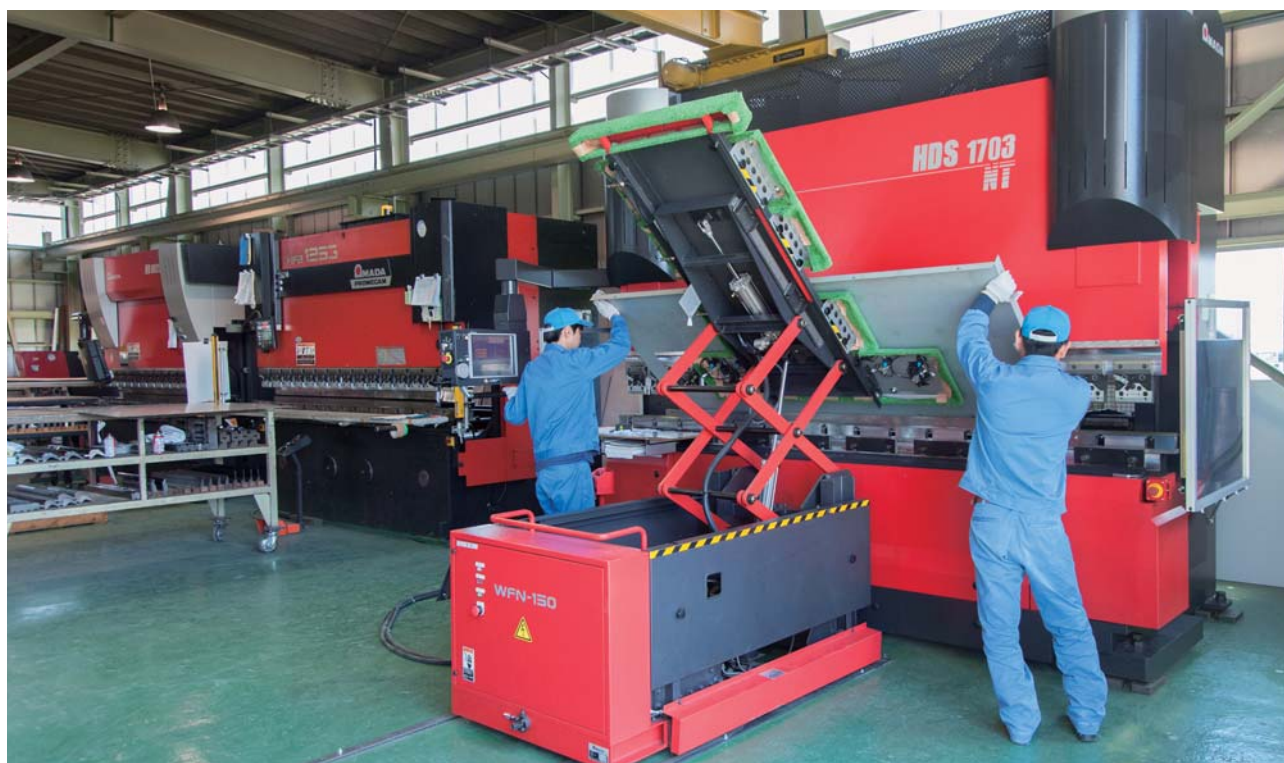
新型ベンドマシン導入でステンレス3mm厚にも対応可能となった。
