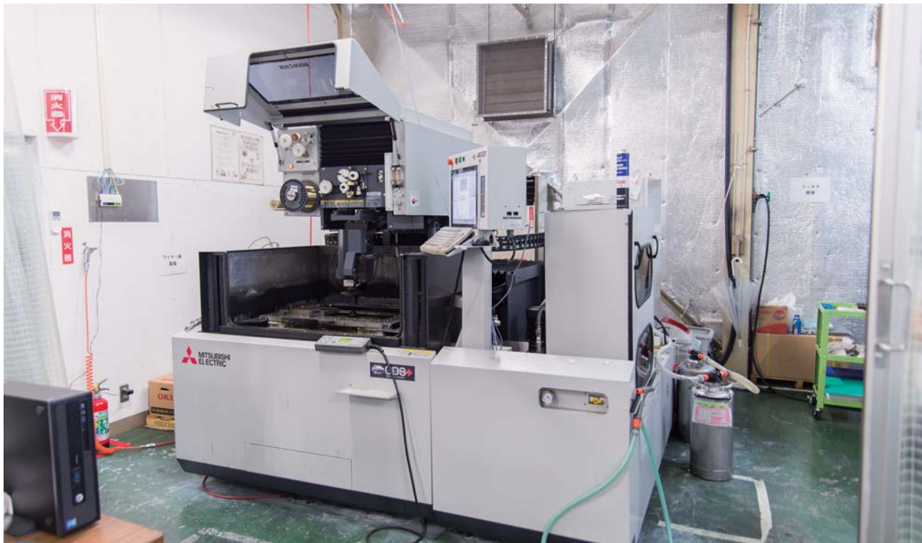
導入したワイヤーカット放電加工機で金型の素材を精密に早く切ることが可能になった。
