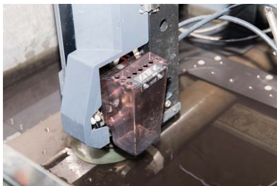
ワイヤーカット放電加工機稼働の様子。
